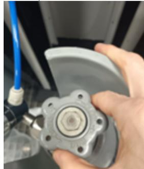
4. Débrancher le flexible à la sortie de la bouteille en poussant sur la bague du raccord
