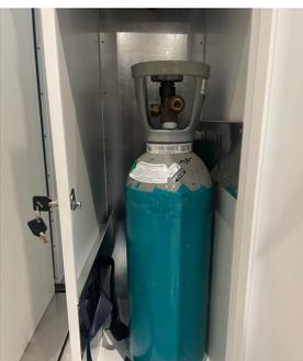
10. Rebrancher le flexible à la sortie de la bouteille
