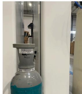
8. Visser le détendeur sur la nouvelle bouteille avec une clé à molette (vérifier que le joint soit resté à l'intérieur du détendeur)
